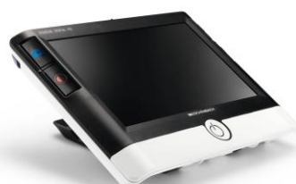
携帯用拡大読書器 ：画面 7 インチ。1024×600px 液晶モニター。サイズ 201×138×29 mm。重さ 460g。倍率 2 倍～22 倍。カラー、白黒反転など 14 種。明るさ調節 3 段階。連続使用時間 4 時間。
